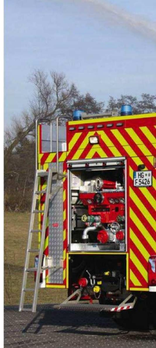
Am Heck des GTLF ist die in Hessen zugelassene zweifarbige Warnmarkierung aufgebracht. Die Heckblaulichter sind mittig angeordnet. Unterhalb des GR liegen die Anschlüsse für Tankbefüllung, Fremdsaugen FireDos sowie Schaummittelbehälter füllen. 50 Meter lang ist der Druckschlauch DN 25 für den Schnellangriff im G4. Bestückt ist er mit einem Hohlstrahlrohr. Im Fach darunter lagern Kombischaumrohr sowie der Multischaumadapter Polymousse für das Hohlstrahlrohr.
