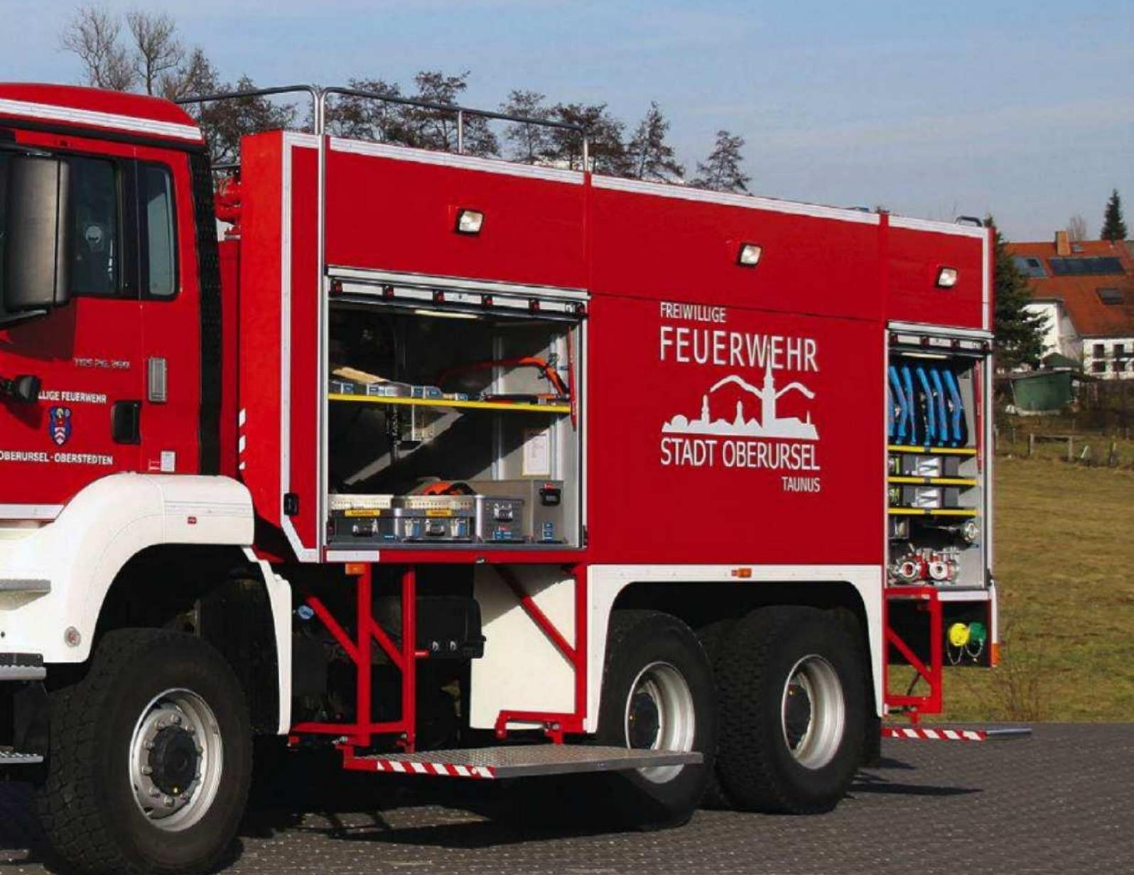
Die FF Oberstedten erhielt von der Firma Empl Deutschland dieses GTLF 7000 auf MAN TGS 26.360 6x6 BB. Das Fahrzeug dient als Löschmittelzubringer im gesamten Stadtgebiet von Oberursel, zu dem Oberstedten gehört. Ein Sprühbalken unterhalb der Stoßstange liefert Wasser zum Reinigen von Straßen oder als Selbstschutz im Flächenbrandeinsatz.
