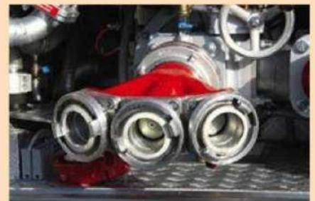
Um die volle Monitorleistung nutzen zu können, muss eine entsprechende Wasserversorgung an der Feuerlöschkreiselpumpe zur Verfügung stehen. Dazu ist ein Sammelstück A-3B an Bord.
