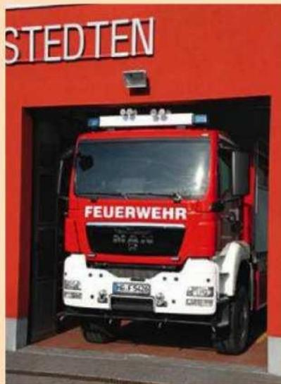
Bei der Ausfahrt aus dem Tor wird es zwischen der auf den Blaulichtbalken aufgesetzten Martin-Kompressoranlage und dem Sturz ganz schön eng.
