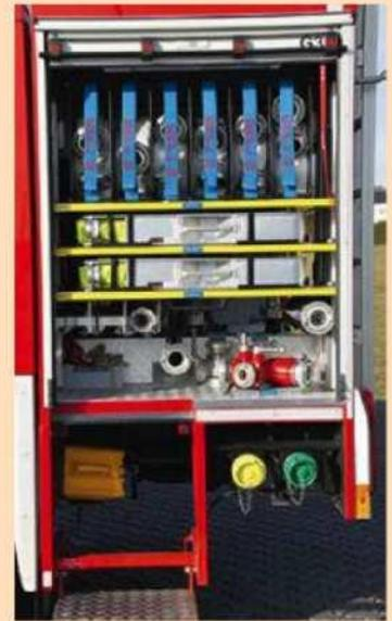
Neben B-Rollschläuchen und zwei C-Schlauchtragekörben lagern im G3 auch ein Verteiler 2B-CBC und Mehrzweckstrahlrohre.
