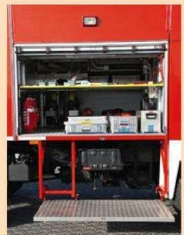
Die Geräteräume G1 und G2 sind miteinander verbunden. Klappen erleichtern die Geräteentnahme. Hier ist einfaches Werkzeug verstaut. Oben sind die Wasser- und Schaummittelzuleitungen zum Dachwerfer zu erkennen.
